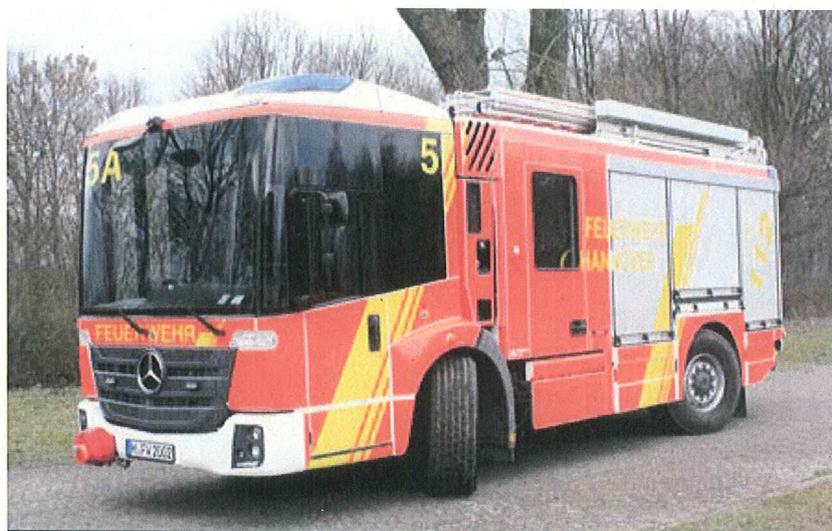
Das neue Hilfeleistungslöschfahrzeug HLF 20 der Feuerwehr Hannover auf einem Mercedes-Benz Econic 1830-Fahrgestell mit einem Aufbau von Magirus-Lohr erfüllt die Euro-6-Norm.
