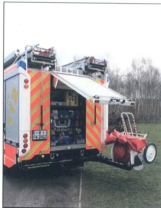
Im hinteren Geräteraum ist eine zweistufige Normaldruck-Kreiselpumpe FPN 10-3000 verbaut.
