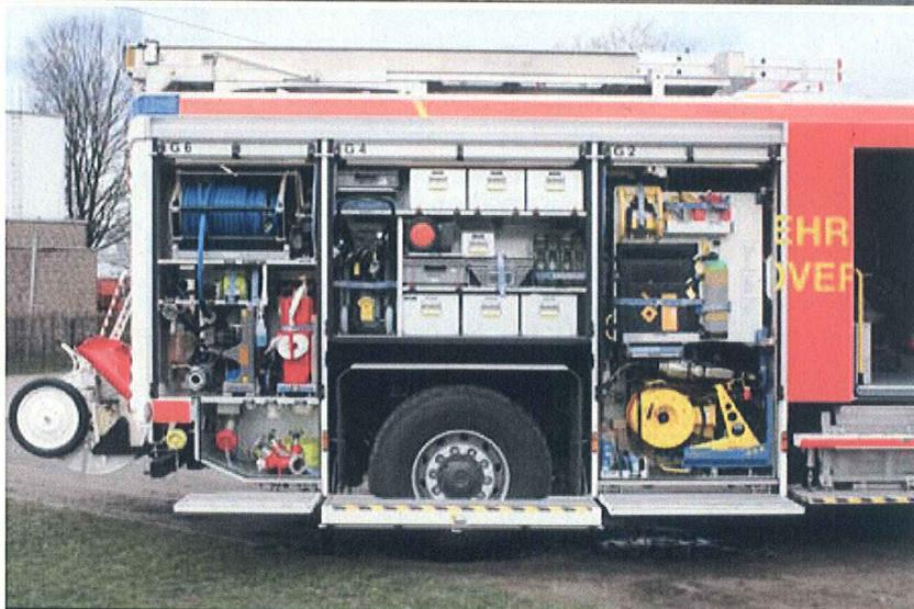
oben: Seitenansicht: Hinter der Drehwand im Geräteraum G1 sind unter anderem ein Motortrennschleifer und ein Erdungsset der Deutschen Bahn AG gelagert.
